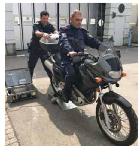
Überprüfung der Bauartgeschwindigkeit am Rollentester.
